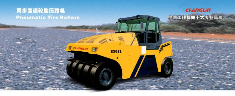
本系列是光面轮胎压路机,主要适合于路面工程中各种粘性和非粘性材料,如沙土,碎石,稳定土、沥青混凝土,干硬性混凝土等材料的压实,尤其适宜于高等级公路的沥青面层的最终处理,是建设高等级公路、机场、市政工程及工业场地的高性能压实设备。
