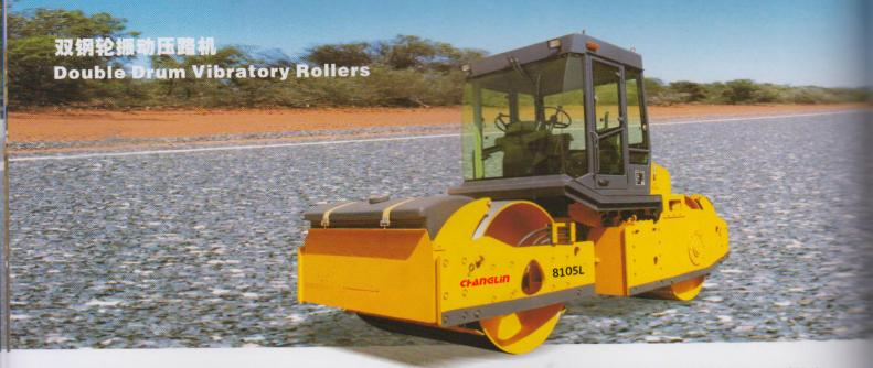
本系列为机械传动液压振动双钢轮振动压路机,主要适合于路面工程的各类材料,稳定土、沥青混凝土材料的压实,是建设公路、市政工程及工业场地的理想压实设备。
