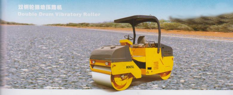
该机是两轮串联振动压路机,适用于各类稳定土、沥青混凝土材料的压实工程,也可用于道路修补、人行道和体育场的碾压工作,是建设公路、市政工程及工业场地的理想压实设备。
